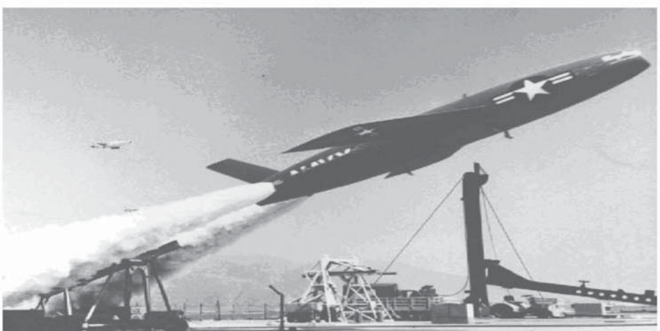
رگولوس؛ یکی از اولین موشک‌های کروزر آمریکا که کپی V-1 آلمانی بود. ببینید چقدر شبیه هواپیماست.
